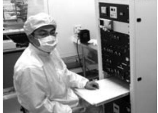
これまでに慢性関節リウマチなどの治療実績のあるAuを手掛かりに、細胞へのAuイオン注入を実施、細胞機能評価を通じて生きた細胞に対するドーピング効果を検証しました。凍結状態の細胞がイオンビームの電気的操作のため保たれる高真空環境に耐性を有することを確認し、Au量を制御して筋芽細胞に導入したところ、未注入のコントロールと比較して細胞活性が増加することが明らかとなりました。通常、重金属の過剰摂取は細胞死（アポトーシス）をもたらすのが常識ですが、ドースの精密制御によって、細胞機能が改質された可能性が高いと考えています。今後も細胞機能修飾を通じて生体機能を解明し、予防、診断、治療に貢献するために、半導体物性制御用に開発された精密なイオン注入法の細胞生物学研究への新展開を図って参ります。
